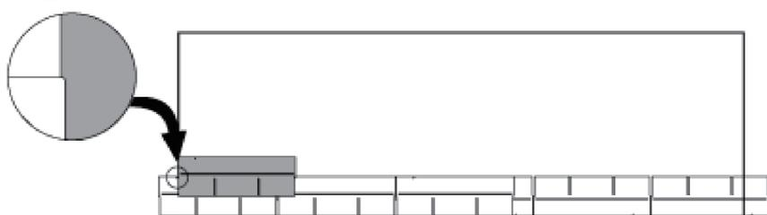
④ 2列目は「捨て貼り」と左端が同じ位置になるようにします。このように前列で貼ったシングル材の「継ぎ目」が常に隠れるように貼ってゆくのがポイントです。前列で貼ったシングル専用釘が必ず隠れるようにして下さい。この為には、①の「シングル専用釘の位置」で釘を打つ必要があります。
