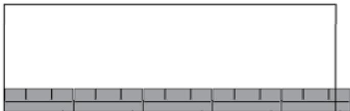
② 左図のように上下を逆に貼ります。この様に逆向きに貼るのは1列目のみですので2重目を逆にしないように注意して下さい。右側に飛び出した部分はカッター等で切り落として下さい。
